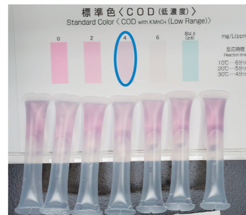
図1. COD標準液4mg/Lのときの発色(20℃ 5分後の測定)
